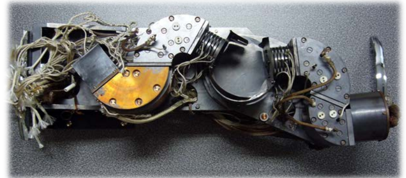
京都大学の研究室で自作したEELS装置
